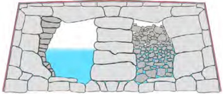
GRAVEL FILL - ACCESSIBLE RESEERVOIR
